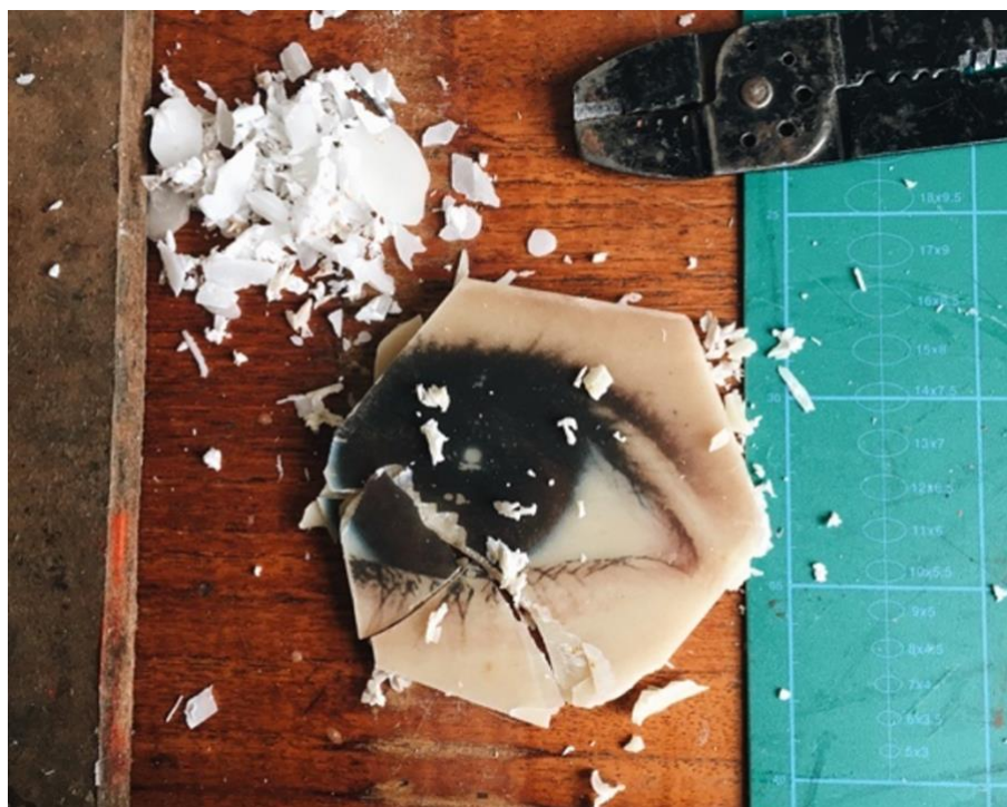
Figura 5. Tiempo: 60 min. Material: Cera virgen de abeja. Papel Transfer: Reflex Perfect Transfer . Temperatura: 70°C Tiempo: 60 min
