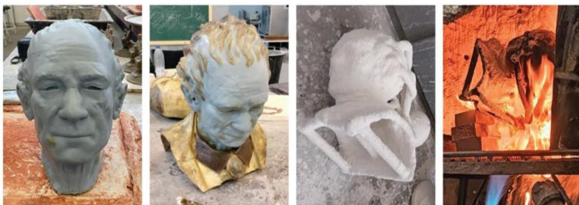
Figura 20: Modelo en PLA, intervención manual en cera, árbol de colada y molde refractario, extracción de la cera y el PLA del interior del molde (descere).
