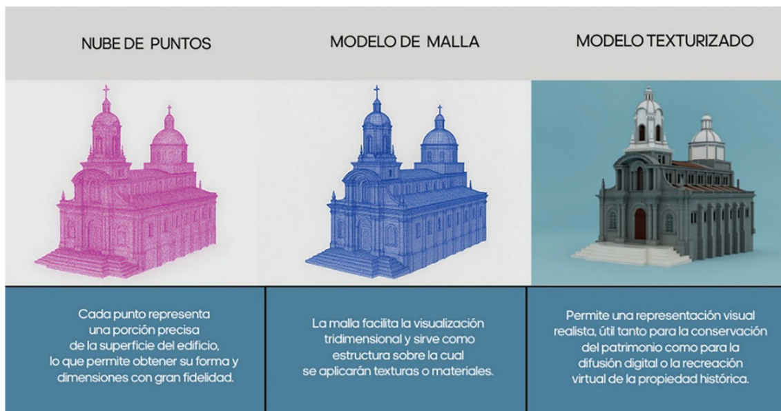
Figura 3: Modelo HBIM de la Iglesia San Antonio de Padua, donde la geometría tridimensional se integra con información semántica y constructiva para la lectura interdisciplinaria del patrimonio.
